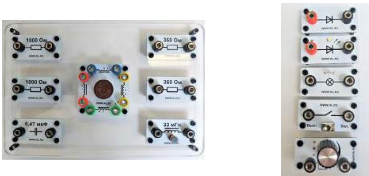
Рис. 17. Дополнительные элементы электрических цепей
