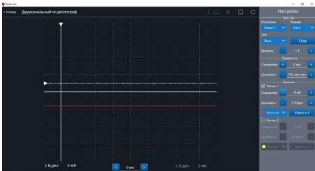
Рис. 40. Сигнал с ненулевым смещением
